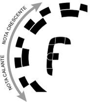
La nota da accordare è mostrata nella parte centrale della schermata. Le bande stroboscopiche scorrono in senso antiorario (verso sinistra) se la nota visualizzata dello strumento è **calante** o in senso orario (verso destra) se la nota visualizzata dello strumento è **crescente**. Quando l'immagine si stabilizza o si "blocca", la nota dello strumento è intonata con un'accuratezza prossima a 0,1 cent di tono (1/10 di cent) della nota visualizzata.
